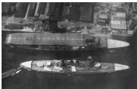
上 巡洋戦艦から設計変更された航空母艦「赤城」 下 湾曲煙突時代の戦艦「長門」
